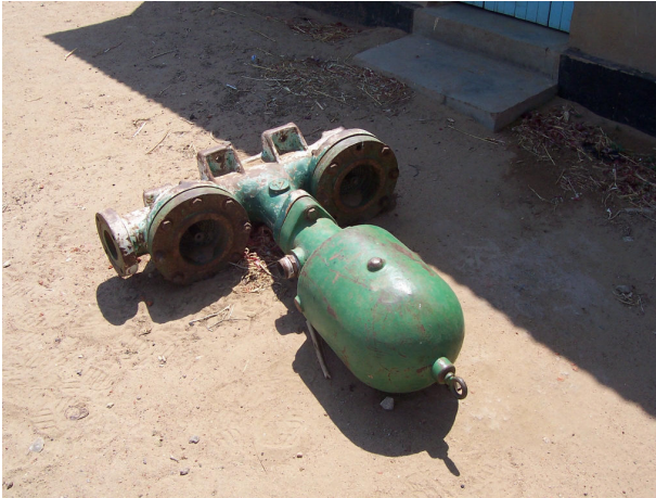
Figura 21 bomba de ariete desmontada (Barazani, Tanzania, J.A.Mancebo 2007)
